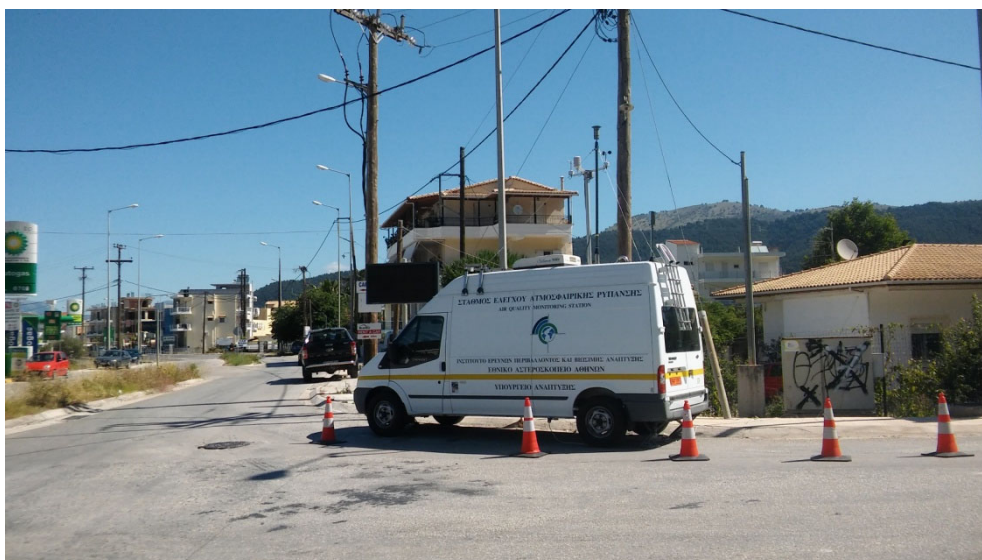
Εικόνα 8. Κινητός Σταθμός Ελέγχου Ατμοσφαιρικής Ρύπανσης και Θορύβου (κατά τη διάρκεια μετρήσεων στην Ηγουμενίτσα, στο πλαίσιο του προγράμματος ΕΓΝΑΤΙΑ ΟΔΟΣ).
