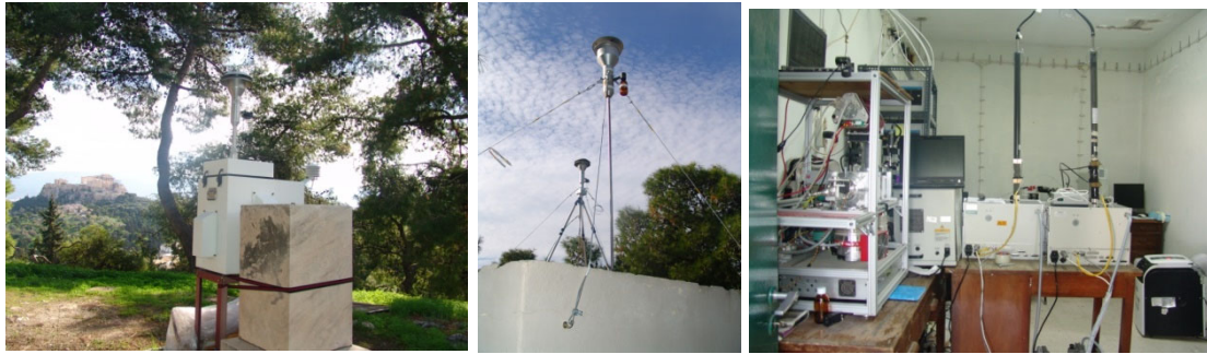
Εικόνα 7. Αστικός Σταθμός Παρακολούθησης Ατμοσφαιρικής Ρύπανσης στο Θησείο: (αριστερά) Δειγματολήπτης αιωρούμενων σωματιδίων ΑΣ 10 και ΑΣ 2.5 , (μέση) Γραμμές δειγματοληψίας αέριων και σωματιδιακών ρύπων στην ταράτσα του κυρίως κτιρίου, (δεξιά) εσωτερικός χώρος και μετρητικά συστήματα.
