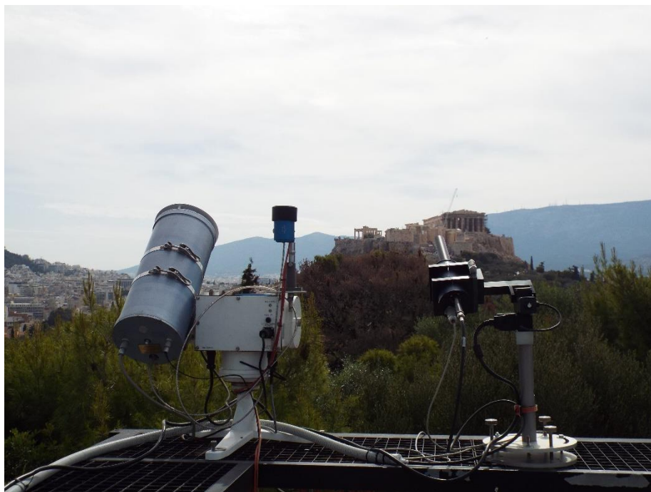
Εικόνα 3-10. Ο εξοπλισμός φασματικής καταγραφής της ηλιακής ακτινοβολίας – PSR και PANDORA- εν λειτουργία στον ακτινομετρικό σταθμό του ΙΕΠΒΑ/ΕΑΑ στο Θησείο.
