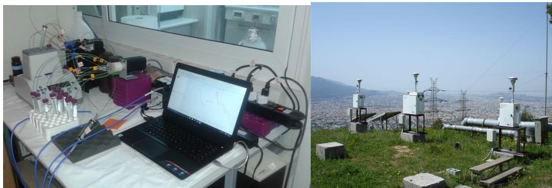
Εικόνα 3-1. (α) Ημιαυτοματοποιημένο αναλυτικό σύστημα για τον προσδιορισμό των δραστικών οξειδωτικών ενώσεων, (β) Δειγματολήπτες αιωρούμενων σωματιδίων ΑΣ10 και ΑΣ2.5 στην Πεντέλη..
