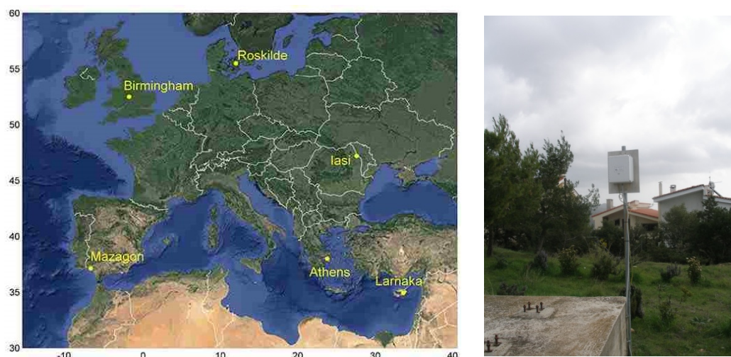
Εικόνα 3-6. (α) Γεωγραφική κατανομή των αισθητήρων του συστήματος ZEUS, (β) Η εξωτερική μονάδα ανίχνευσης των ηλεκτρικών εκκενώσεων.
