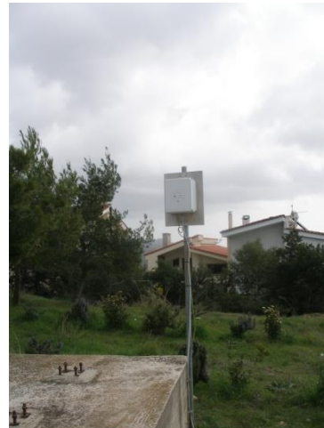
Εικόνα 3-5. (α) Γεωγραφική κατανομή των αισθητήρων του συστήματος ZEUS, (β) Η εξωτερική μονάδα ανίχνευσης των ηλεκτρικών εκκενώσεων.
