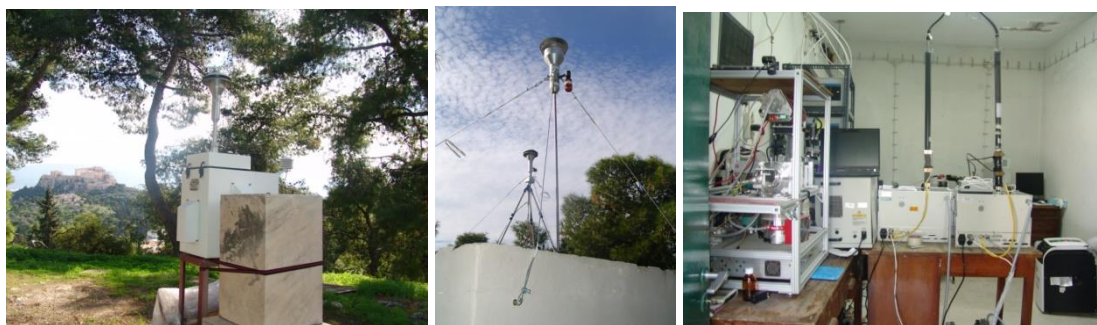
Εικόνα 3-2. Αστικός Σταθμός Παρακολούθησης Ατμοσφαιρικής Ρύπανσης στο Θησείο: (αριστερά) Δειγματολήπτης αιωρούμενων σωματιδίων \text{A}\Sigma_{10} και \text{A}\Sigma_{2.5} , (μέση) Γραμμές δειγματοληψίας αέριων και σωματιδιακών ρύπων στην ταράτσα του κυρίως κτιρίου, (δεξιά) εσωτερικός χώρος και μετρητικά συστήματα.
