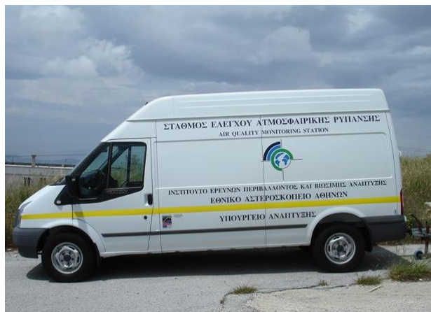
Εικόνα 3-3. Κινητός Σταθμός Ελέγχου Ατμοσφαιρικής Ρύπανσης και Θορύβου.
