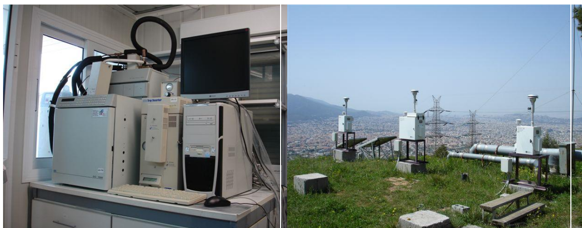
Εικόνα 3-1. (α) Αέριος χρωματογράφος με ανιχνευτή ιονισμού φλόγας, (β) Δειγματολήπτες αιωρούμενων σωματιδίων ΑΣ 10 και ΑΣ 2.5 στην Πεντέλη.
