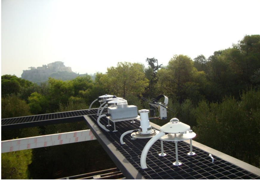
Εικόνα 3-7. Μερική άποψη του ΑΣΕΑΑ. Διακρίνονται τα όργανα μέτρησης ολικής ηλιακής ακτινοβολίας, ολικού φωτισμού, υπέρυθρης και υπεριώδους ακτινοβολίας.
