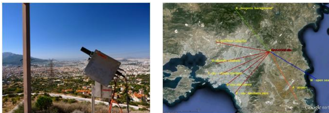
Εικόνα 4.2.2. (α) Το σύστημα Max-DOAS που εγκαταστάθηκε στις εγκαταστάσεις του ΕΑΑ στην Πεντέλη, (β) οι κύριες αζιμουθιακές διευθύνσεις με διαφορετικά χαρακτηριστικά ρύπανσης.
